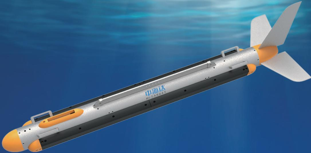
多波束侧扫是侧扫声呐领域最高端系列产品，系统采用先进的动态数字自动聚焦技术，极大提高沿航迹方向的分辨率，特别适合水雷排查、应急搜救、小目标搜寻等应用场景。作业速度高达12节，极大提高扫测效率，同时针对浑浊水域或大面积扫测，iSide 7000高分辨率动态聚焦多波束侧扫声呐兼容低速双频扫测模式，可实时在线切换，实现高速和高分辨率得完美结合。
